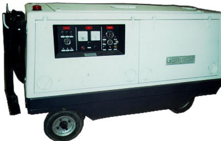
Le groupe électrogène « **GUINAULT** » type **DU 630** a été conçu pour assurer l'alimentation des installations et des équipements avion utilisant un courant continu de 28,5 Vdc.
